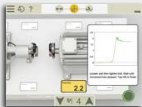
对两台机器进行地脚检查
